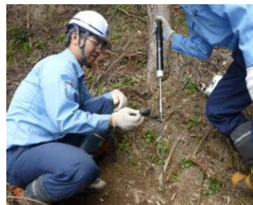
ベーンコーンせん断試験
