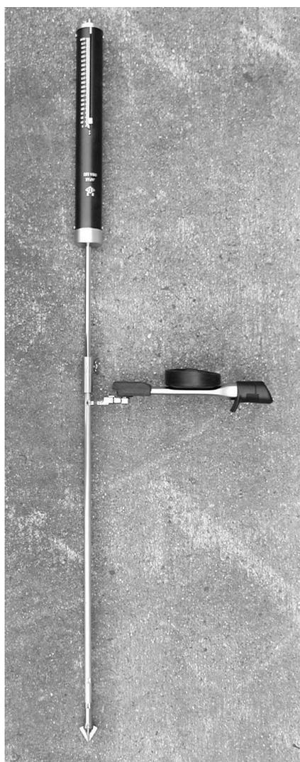
写真 8-1 ベーンコーンせん断試験の外観
